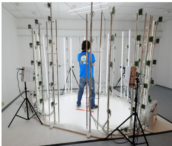
Slika 19 Primjer 3D skenera sa više kamera koje istovremeno prikupljaju informacije o skeniranom modelu
