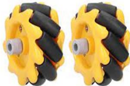
Slika 1. Mekanum točak specifikum RoboLab platforme
