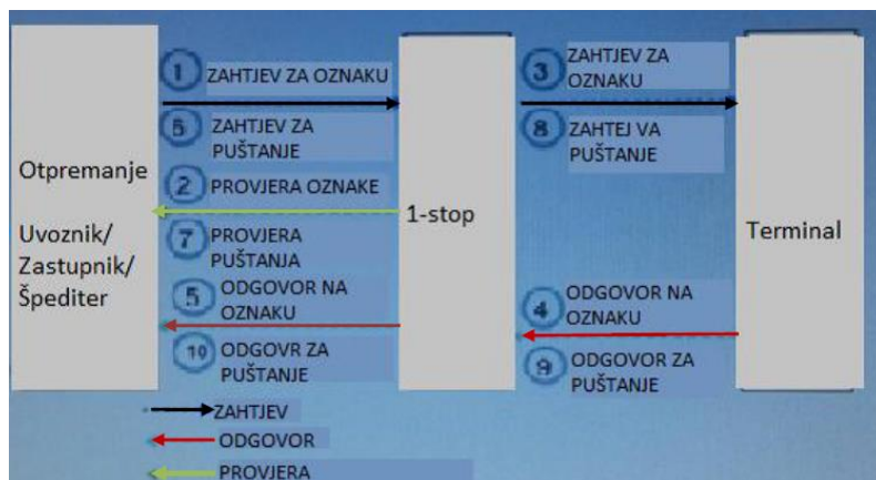
Slika 5. Prikaz toka podataka u RTR sistemu [4]
